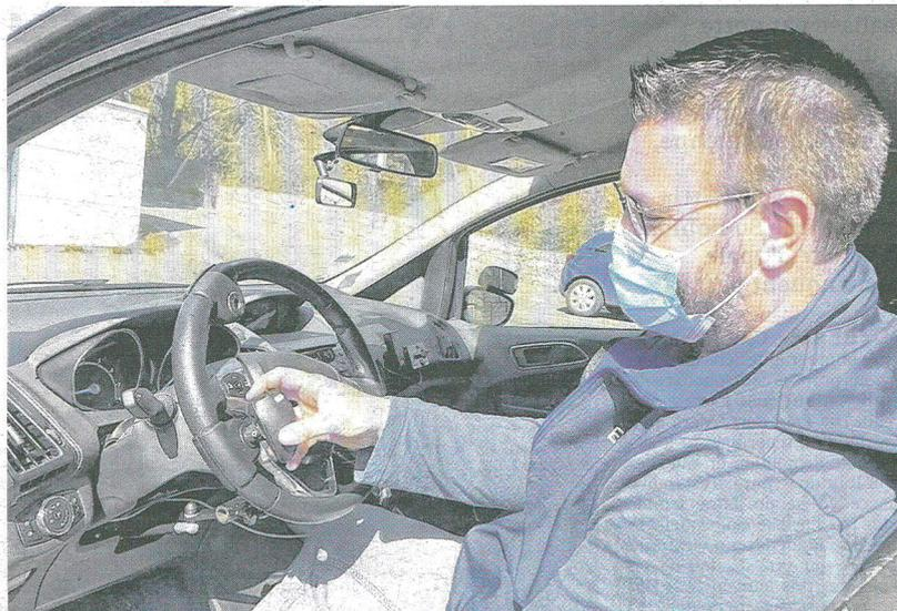
Thibaud Maquinghen, moniteur auto-école dans des véhicules adaptés, manipule une boule qui fait office de volant. Celle-ci est manœuvrable d'une seule main.
